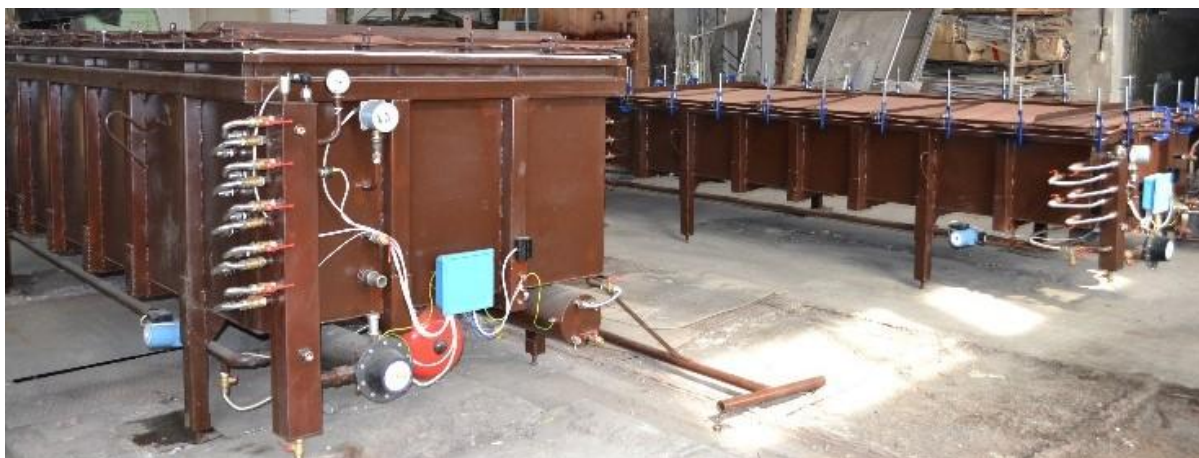
Рис.1. Камеры «Энергия ПВ2» и «Энергия ПВ1».
