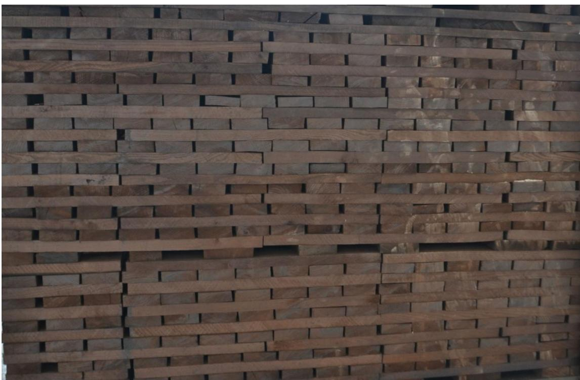
Рис. 2. Ясень после сушки и термообработки при 200°C.
