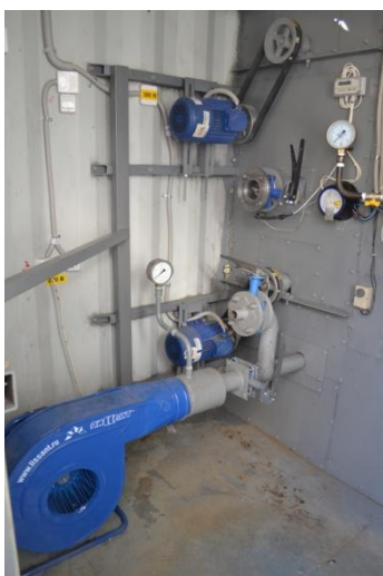
Рис. 8. Управление пневмоприжимом ( при наличии) и притоком воздуха.
