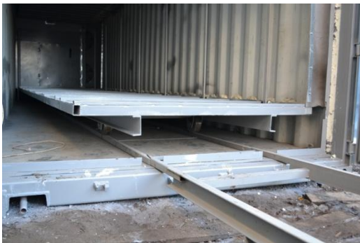
Рис.4а. Тележка и откидные рельсы.
