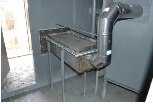
Рис.8а . Камера сгорания открытого типа с верхней ванной испарения.
