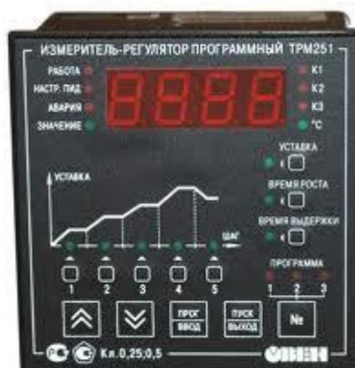
Рис. 6 . Программный измеритель-регулятор TRM 251. Панель управления.
