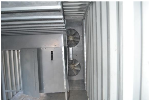
Рис. 7а .Маршевые вентиляторы , отверстие для крепления тросика контроля усадки и пневмоприжим.
